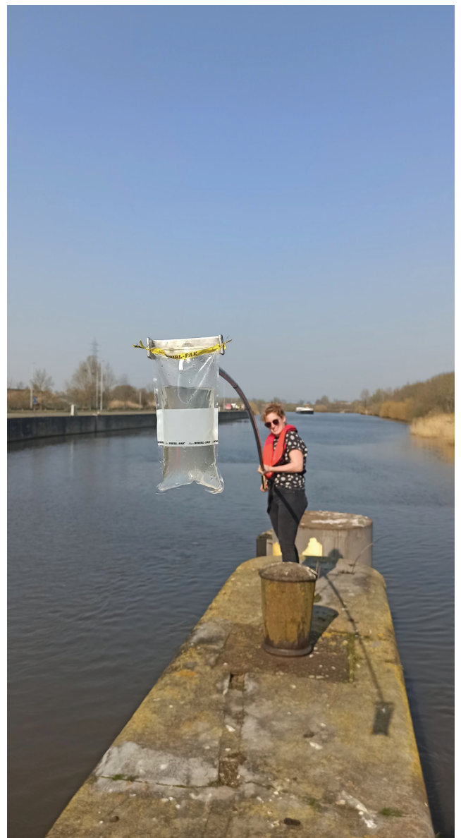
Figuur 2. Om een eDNA-staal te nemen, gebruiken we een staalnamestok en hoeven we het water niet meer in. (©Teun Everts)
