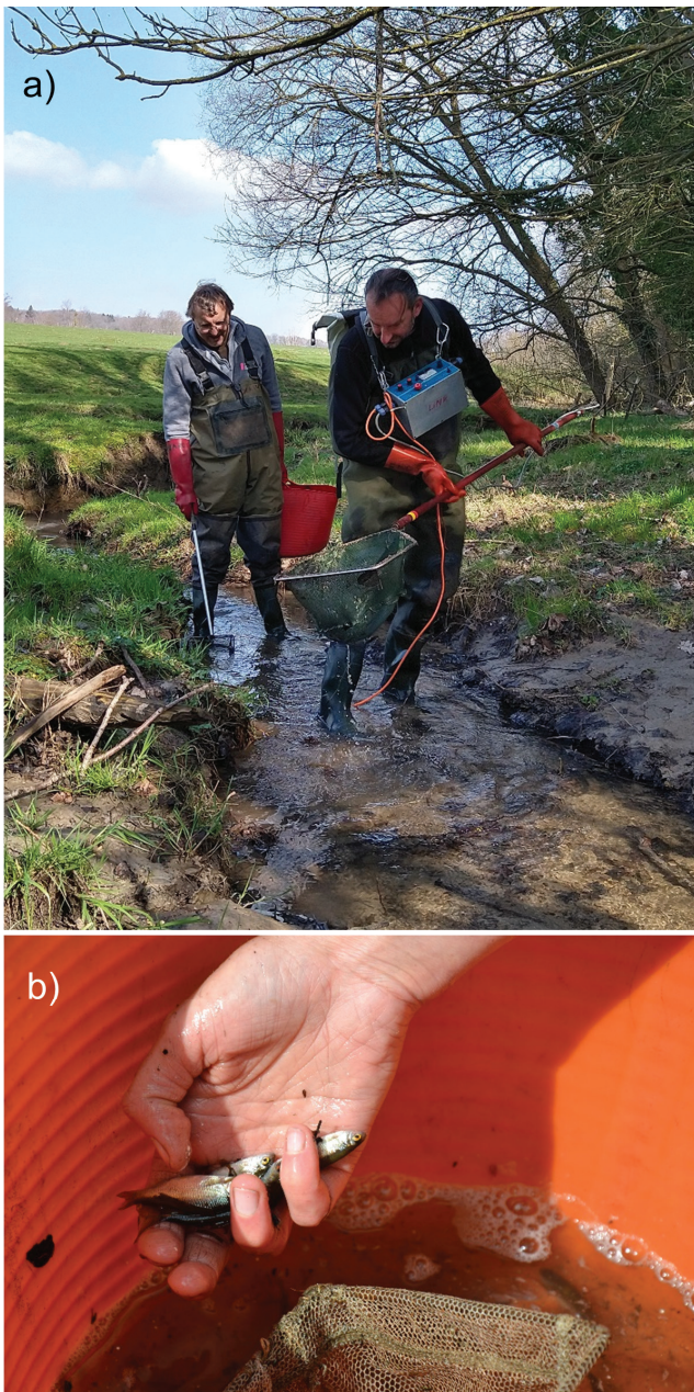
Figuur 1. (a) Elektrisch vissen is een van de meest courante methodes om de aanwezige vissen in beken en rivieren in kaart te brengen. De onderzoekers gaan wadend te water en maken gebruik van elektrodes om de vis tijdelijk te verdoven. (© Isabel Lambeens) (b) Een deel van de visvangst na een uur elektrisch vissen. (© Adinda De Bruyn)
